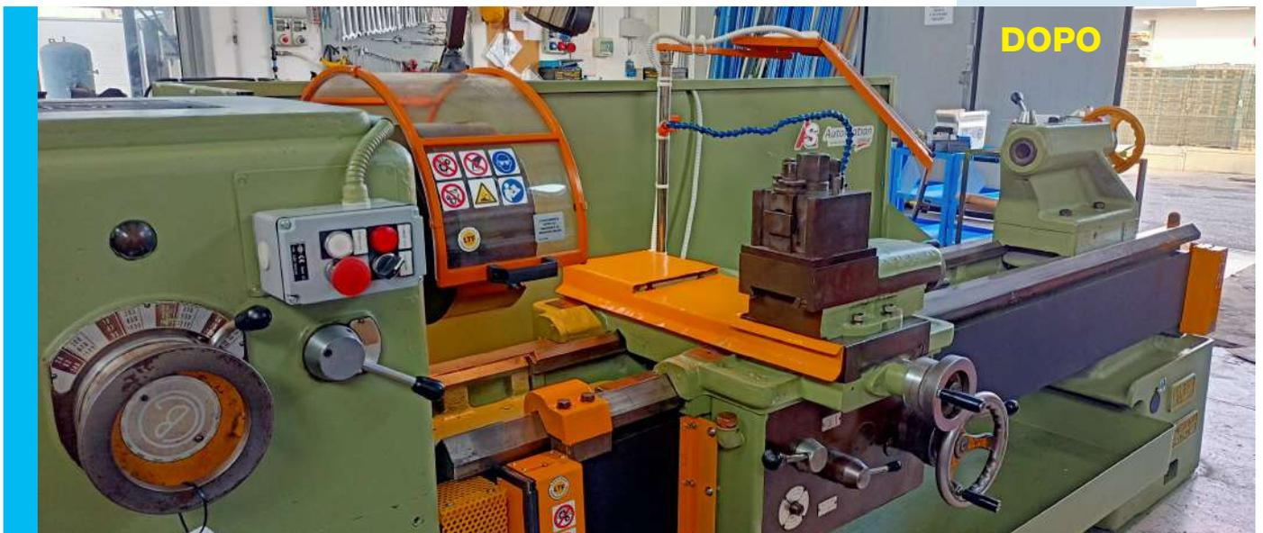
*Installato mandrino frenato e protezioni. E' stato rifatto il quadro elettrico. Adeguati pittogrammi di pericolo. Macchinario adeguato alla normativa vigente e conforme a quanto previsto dall'allegato V) del DPR 31/2008.*
