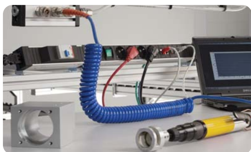
Alimentazione elettrica, pneumatica e rete dati inglobate.
